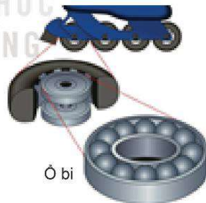
Hình 18.6. Con lăn hoặc ổ bi đặt xen giữa vào hai mặt tiếp xúc
