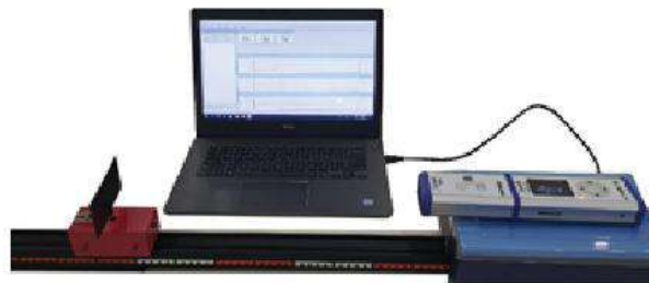
Hình 6.7. Cảm biến chuyển động Hình 6.8. Đo tốc độ bằng cảm biến chuyển động
