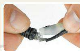
c) Dây điện bị sờn
