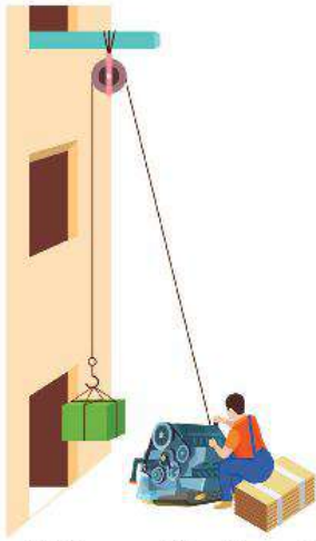
a) Động cơ điện đưa vật nặng chuyển động từ dưới đất lên cao
