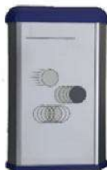
Hình 6.7. Cảm biến chuyển động Hình 6.8. Đo tốc độ bằng cảm biến chuyển động
