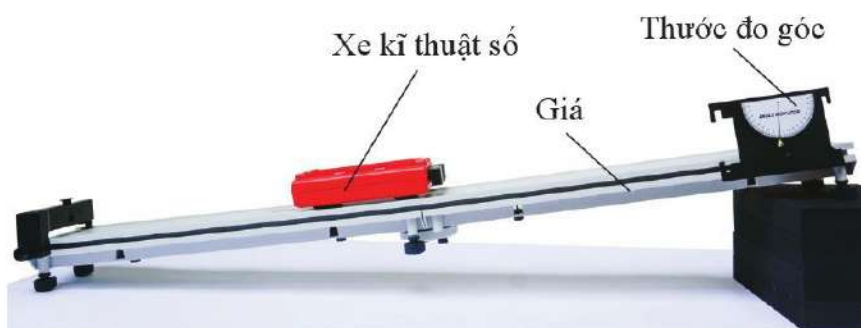
Hình 1.6. Đo tốc độ của xe (dùng xe kĩ thuật số)
