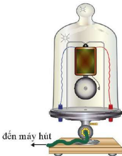
Hình 8. Thí nghiệm âm thanh không truyền được trong chân không
