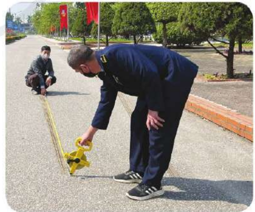
Hình 4.1. Thanh tra giao thông đo vết phanh xe trong kiểm tra tốc độ xe khi phanh
