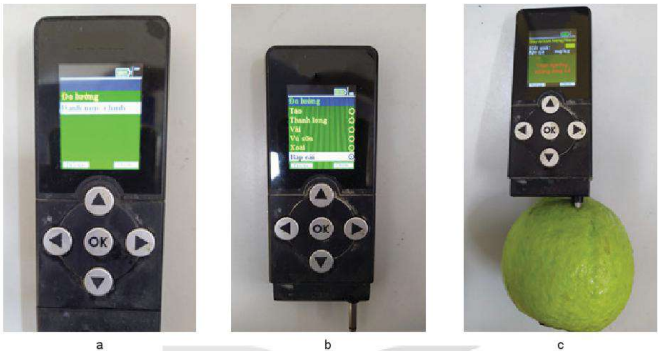
Hình 14.2. Một số bước sử dụng thiết bị đo hàm lượng nitrate
