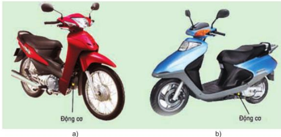
Hình 34.2. Bố trí động cơ trên xe máy
